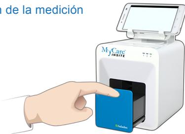
Al final de la medición, la puerta se abre y el resultado aparece en la pantalla táctil. Retire el cartucho de prueba y cierre la puerta para el siguiente análisis.
