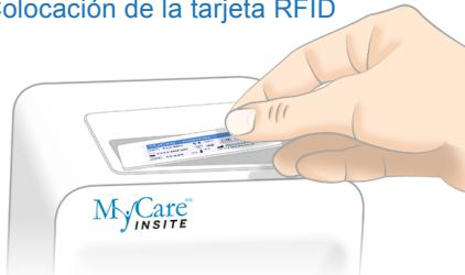
Saque la tarjeta RFID suministrada del kit de pruebas y colóquela en la ranura para las tarjetas RFID en la parte superior del analizador.
