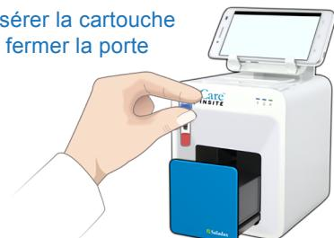
La porte s'ouvre automatiquement. Insérer la cartouche (cuvette avec bouchon de réactif) dans l'analyseur et fermer la porte. L'analyse démarre automatiquement.
