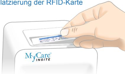
Nehmen Sie die mitgelieferte RFID-Karte aus dem Testkit und legen Sie sie in das RFID-Kartenfach oben auf dem Analysegerät.
