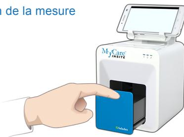
À la fin de la mesure, la porte s'ouvre et le résultat apparaît sur l'écran tactile. Retirer la cartouche d'analyse et fermer la porte pour l'analyse suivante.
