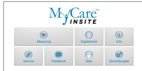
Um eine Messung zu starten, wählen Sie im Hauptmenü. Der MyCare Insite liest die RFID-Karte automatisch und der Bildschirm für den Test wird angezeigt.
