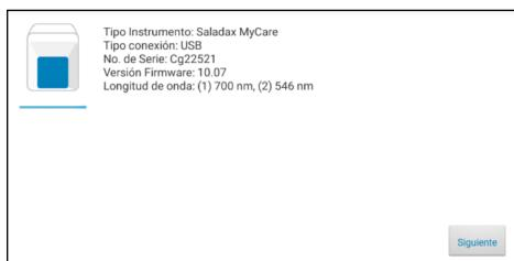
La pantalla de conexión aparece cuando la pantalla táctil se conecta al analizador.
