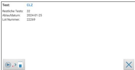
Der MyCare Insite zeigt den Testnamen und die Anzahl der auf der RFID-Karte verbleibenden Tests an.
