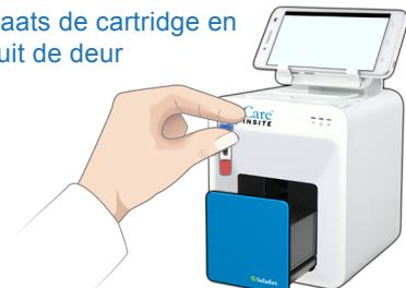
De deur gaat automatisch open. Plaats de cartridge (cuvet met reagensdop) in de Analyser en sluit de deur. De test start automatisch.
