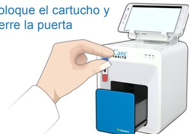
La puerta se abre automáticamente. Coloque el cartucho (cubeta con tapa de reactivo) en el analizador y cierre la puerta. La prueba se inicia automáticamente.
