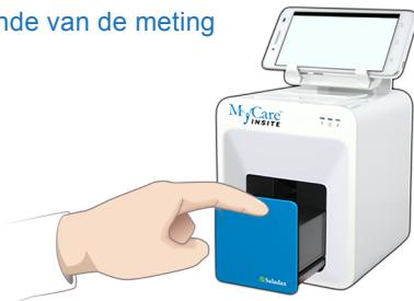
Aan het einde van de meting gaat de deur open en verschijnt het resultaat op het touchscreen. Verwijder de testcartridge en sluit de deur voor de volgende analyse.
