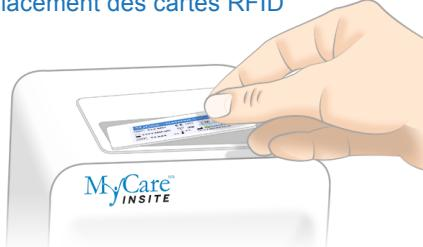
Sortir la carte RFID fournie de la trousse d'analyse et la placer dans le logement prévu à cet effet sur le dessus de l'analyseur.
